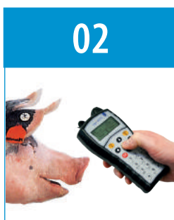
Считывание данных хряка с электронной ушной бирки
