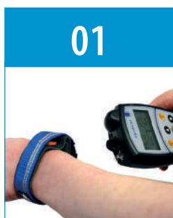
Считывание кода техника с ремешка транспондера
